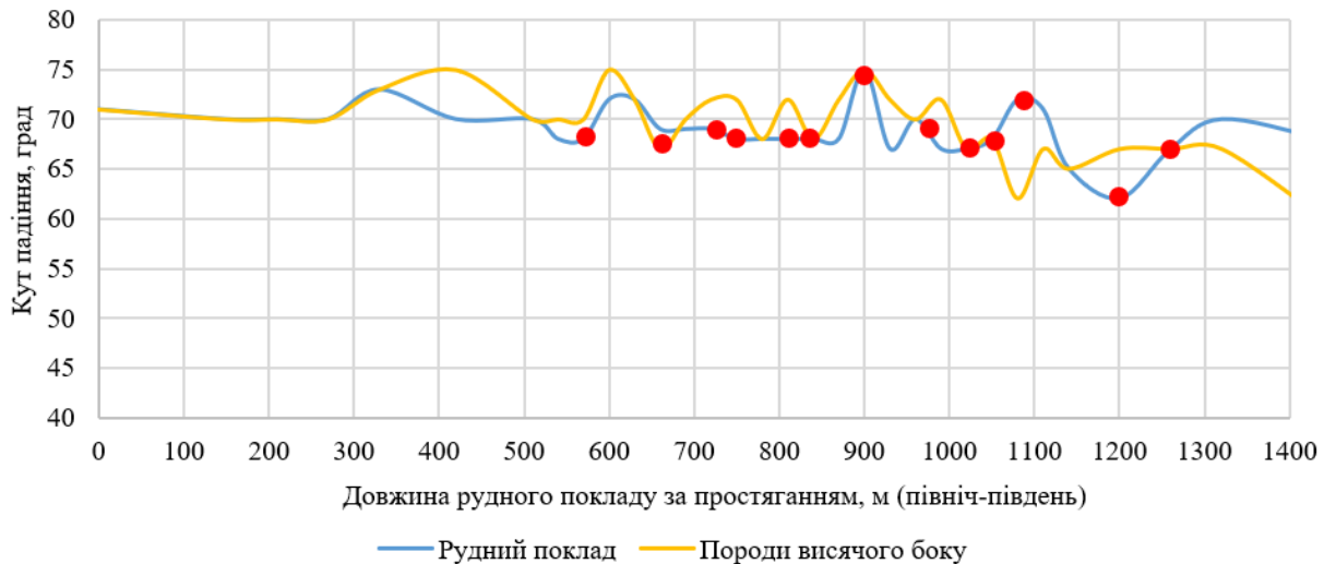
Рис. 5. Характер зміни кутів падіння рудного покладу та порід висячого боку за простяганням
